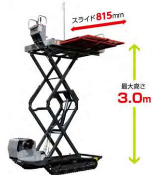
作業台最大積載量(最大作業能力) 120kg又は150kg、下降時200kg (自身+果樹等) 傾斜は5°未満のこと
