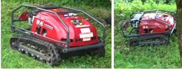
RJ705 <atex> 車重365kg 車速4km/h
