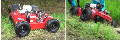
AJK600 <三陽機器> 車重200kg 車速2.6km/h
