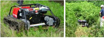
RCM530 <オーレック> 車重138kg 車速2.7km/h
