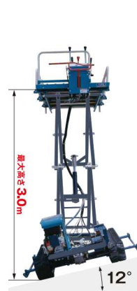
作業台最大積載量 120kg、下降時180kg (自身+果樹等)
