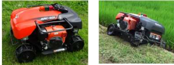
ARC-501 <クボタ> 車重142kg 車速2.23km/h
