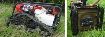
RJ705 <atex> 車重365kg 車速4km/h
