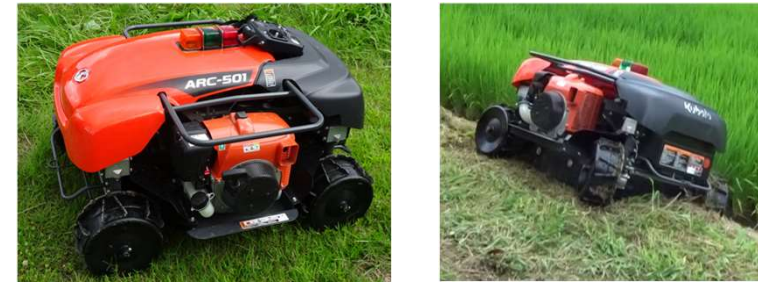
ARC-501 <クボタ> 車重142kg 車速2.23km/h
