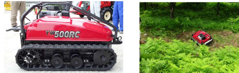
YW500RC <ヤンマー> 車重155kg 車速2.1km/h
