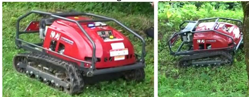
RJ705 <atex> 車重365kg 車速4km/h
