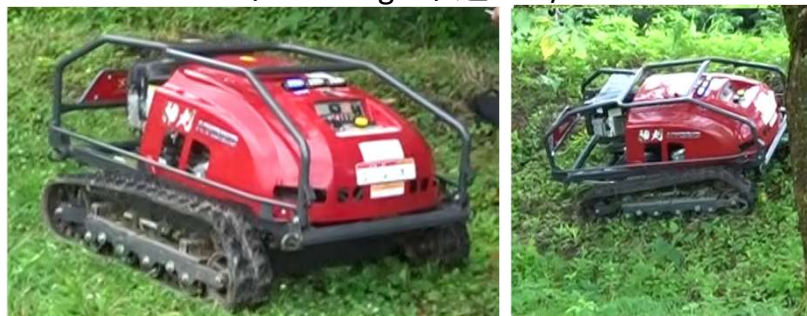
RJ705 <atex> 車重365kg 車速4km/h
