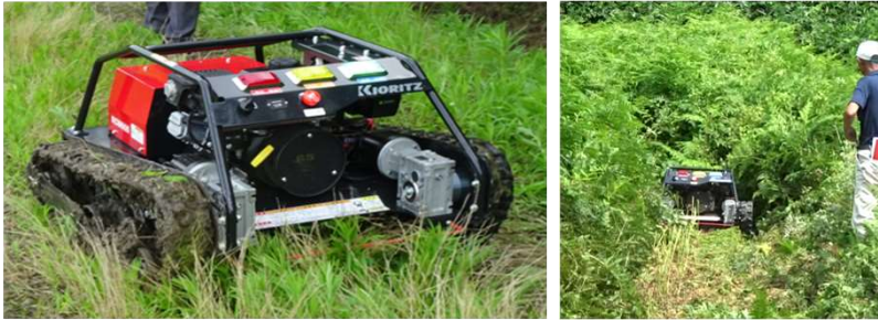
RCM530 <オーレック> 車重138kg 車速2.7km/h
