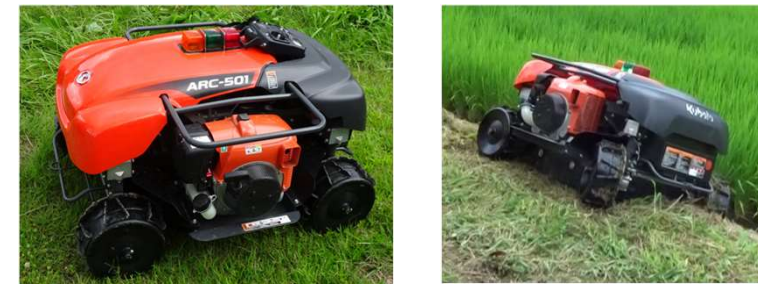
ARC-501 <クボタ> 車重142kg 車速2.23km/h
