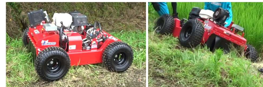
AJK600 <三陽機器> 車重200kg 車速2.6km/h
