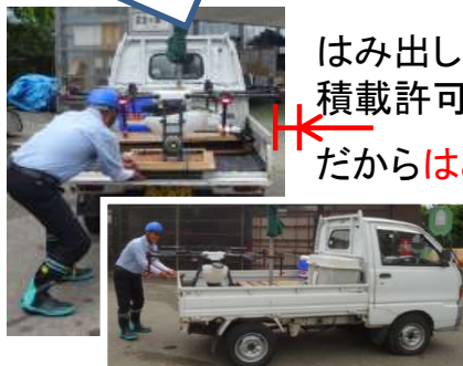
③軽トラの荷台に車幅をはみ出ない様固定して移動する
