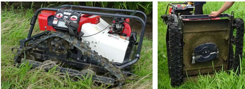
RJ705 <atex> 車重365kg 車速4km/h
