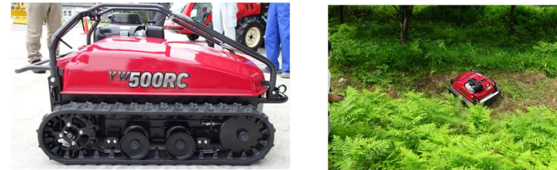
YW500RC <ヤンマー> 車重155kg 車速2.1km/h
