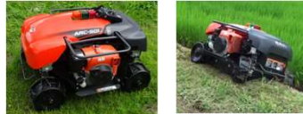
ARC-501 <クボタ> 車重142kg 車速2.23km/h
