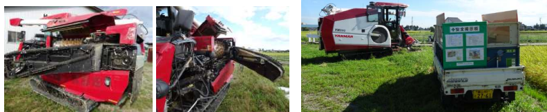
作業前に脱穀部の清掃をする
