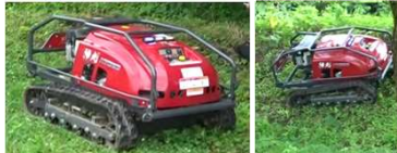
RJ705 <atex> 車重365kg 車速4km/h
