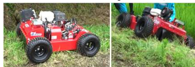
AJK600 <三陽機器> 車重200kg 車速2.6km/h
