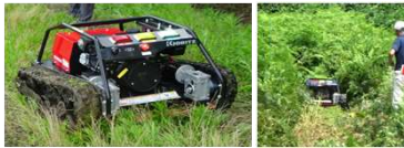
RCM530 <オーレック> 車重138kg 車速2.7km/h
