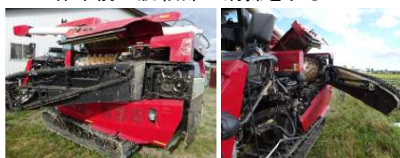
作業前に脱穀部の清掃をする
