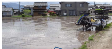
苗床は、代かき直後にGNSS利用し、マーカー無で田植した
