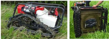
RJ705 <atex> 車重365kg 車速4km/h
