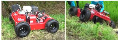
AJK600 <三陽機器> 車重200kg 車速2.6km/h
