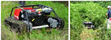
RCM530 <オーレック> 車重138kg 車速2.7km/h
