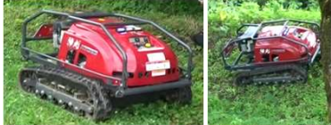
RJ705 <atex> 車重365kg 車速4km/h
