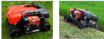
ARC-501 <クボタ> 車重142kg 車速2.23km/h
