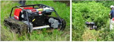
RCM530 <オーレック> 車重138kg 車速2.7km/h
