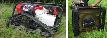
RJ705 <atex> 車重365kg 車速4km/h
