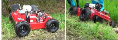
AJK600 <三陽機器> 車重200kg 車速2.6km/h
