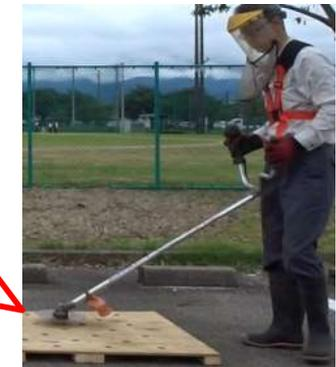
平面は、チップソーを水平に振って飛散を減らす
