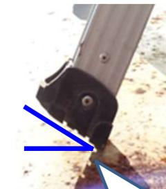
開き止め金具が破損して転落する
