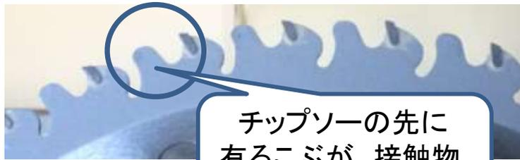
チップソーの先に有るこぶが、接触物の飛散方向を散らす
