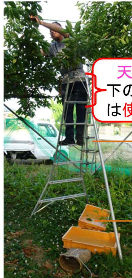
8尺の三脚は天板と下踏棧1段を使用しなければ地上高1.8m以下になる
