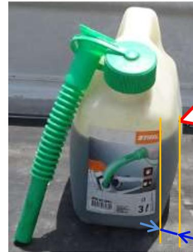
日光に当たり**容器が膨らんだ**状態。ペットボトルキャップが**破裂し漏れ出す**
