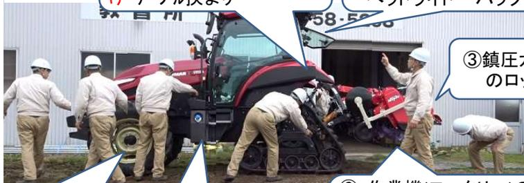
①作業機油圧ガブラ、センサー、灯火器類、他の**接続コネクタ**抜け・ケーブル挟まり
