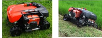
ARC-501 <クボタ> 車重142kg 車速2.23km/h
