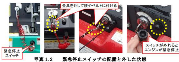
写真 1.2 緊急停止スイッチの配置と外した状態
