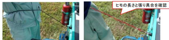
写真 1.3 緊急停止スイッチの着用例
