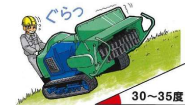
図 1.32 傾斜角 30~35 度の不安定な状態
