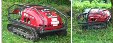
RJ705 <atex> 車重365kg 車速4km/h
