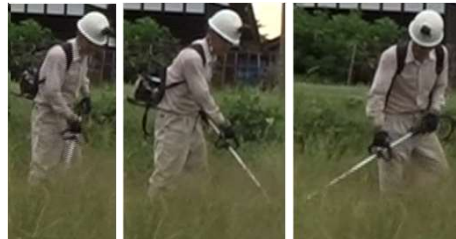
刈幅180cm大振りは、カバーと刈刃の間に草が挟まる
