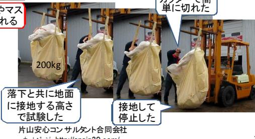
落下と共に地面に接地する高さで試験した 接地して停止した
