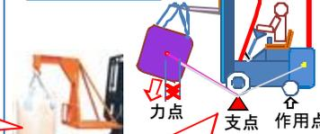
リフトが軽いと、荷振れて後ろが浮き、旋回時は倒れる
