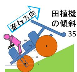
後輪駆動で段差を上がる時、前輪が邪魔をして後退方向がズレて進入路から転落する
