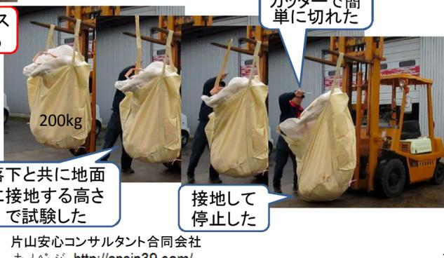
落下と共に地面に接地する高さで試験した
