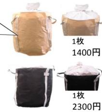
ベージュ色袋の材質ポリプロピレンは40°C前後の温度や直射日光で劣化が進行する。突き刺し・引掛けて力が掛かると破れ、中身が「ザー」と出て後片づけは大変です
