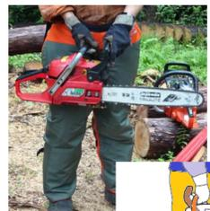
チェーンソーが太ももに当たると、保護ズボンの繊維が抜けてソーに絡みついて停止させる。
