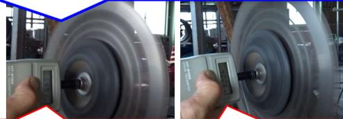
空回転は6491rpmあり、回転数2割減と考え、5200rpmは小石初速250km/hで飛ぶ
