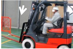
③ マストの高さを下降させて合わせる
