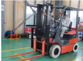
③ マストを起こして爪を床と並行から少し前倒し(前傾)にする
