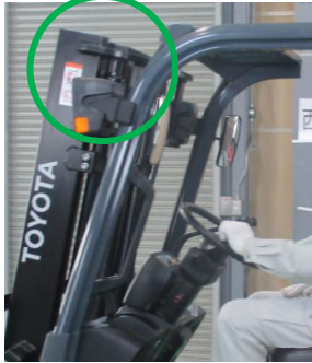
③ マストの高さを下降させて合わせる
