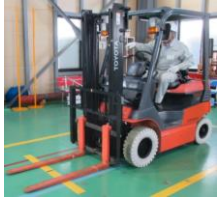
⑤ 前方、後方、前方確認してシートベルトを外し、体を車体に対して後ろ向きに手すりをつかんで降車する
