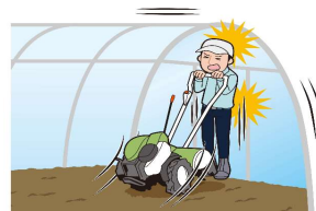
後退時に支柱等に挟まれる
