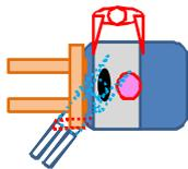
フォークリフトの修理後、オペレータから追加点検を求められた修理者(業者)が、前面下部に潜り再点検していた。依頼したオペレータが現場を離れている間に他者(点検中を知らない社員)が乗車し発進した。点検作業中の被災者の上を進行して、左脇腹から右足を轢いて死亡した事例
