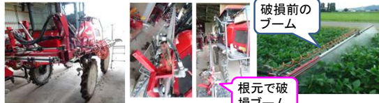
破損前のブーム 根元で破損ブーム 片山安心コンサルタント合同会社 ホームページ http://ansin39.com/
