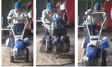
前進時、正転したロータリー爪が 堅い土に当たると、ダッシングする 写真はコンパネに当て跳ね上がった状態
