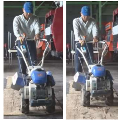
前進時、正転したロータリー爪が 堅い土に当たると、ダッシングする 写真はコンパネに当て跳ね上がった状態
