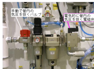
圧抜きに方法の多様性、電磁弁と手動バルブを組み合わせた設計
