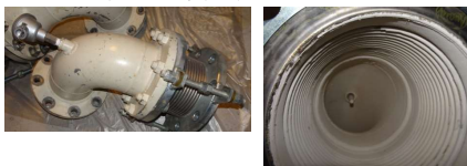
配管の温度測定素子の取付
