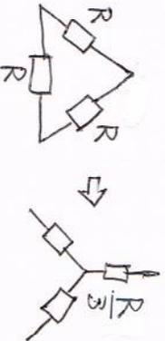
コンビンサの  $\Delta \rightarrow Y$  変換は  $C_\Delta \Rightarrow 3C_Y = C_Y$
