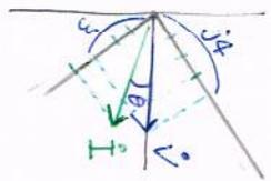
電力は、 $\dot{V}$  と  $\dot{I}$  を乗算するが、電圧を逆位相にすると、誘導上になる遅れ電流によって生じる無効電力を正と定義しているので通合良し。
