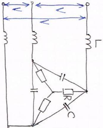
インダクタンスZ [Ω]を求め、リアクタンスX [Ω]分がゼロになるようにする。
