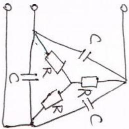
コンビンサ  $C$  を  $\Delta \rightarrow Y$  変換して  $Y$  の 1 相として考える。
