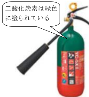
二酸化炭素消火器 噴射時間 14 秒 容量 3.8L 噴出体積 900L 程度
